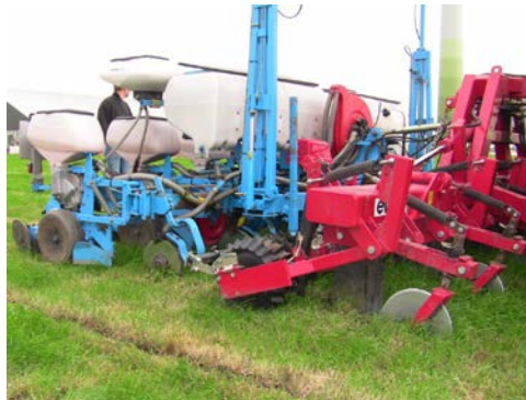
Mais in graszode zaaien met systeem Pol (links, machine gebouwd door Kuipers te Greonterp) en met de Hunter van Evers-Agro (rechts)
